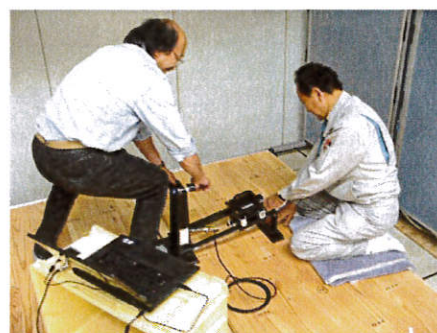
写真3 携帯型床の滑り試験機による試験
